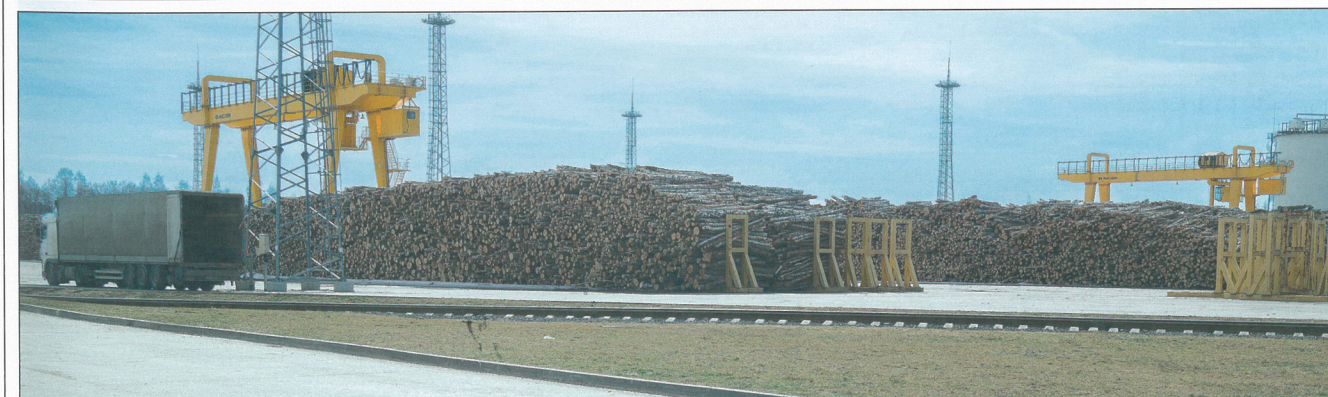
В рамках нового проекта фабрики создана лесная биржа, построен древесно-подготовительный цех и цех для изготовления беленной химико-термомеханической массы, из которой и производится картон
